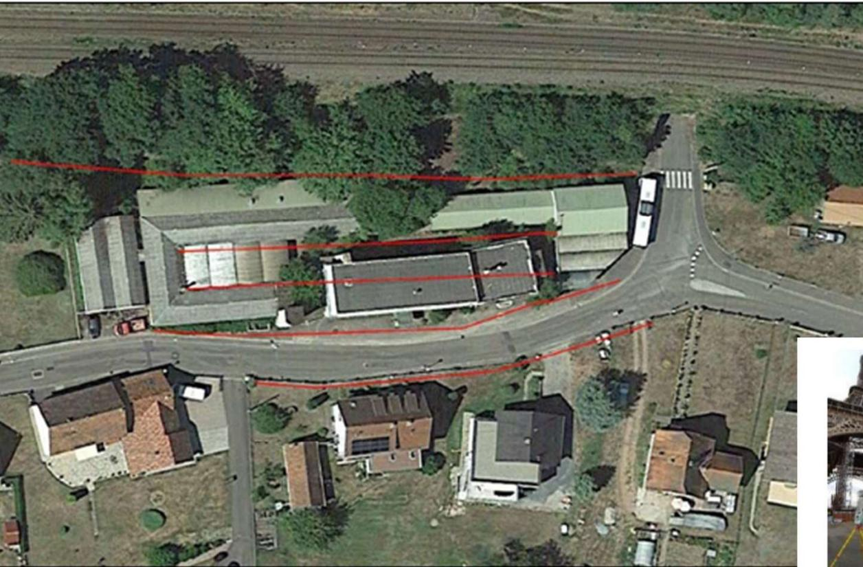
Figure : Localisation du site à investiguer par méthode géoradar et ERT 3D, avec lignes tomographie électrique en rouge (lignes théoriques)
