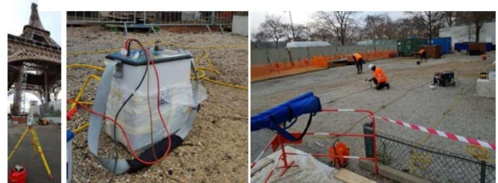
Figure 35 : Exemple d'acquisition ERT 3D avec maillage inter-électrode de 2 mètres et interlignes de 2 mètres
