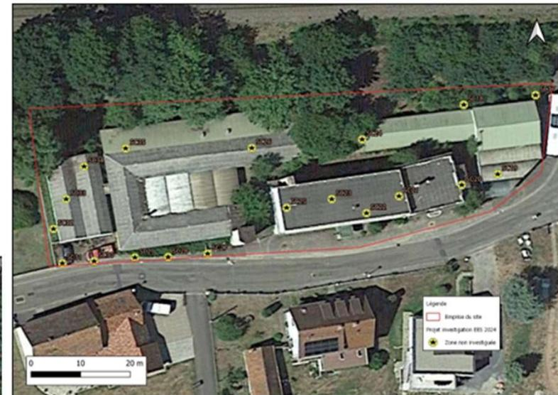
Figure : Localisation prévisionnelle des sondages sous-gaine au droit des zones non investiguées jusqu'à présent
