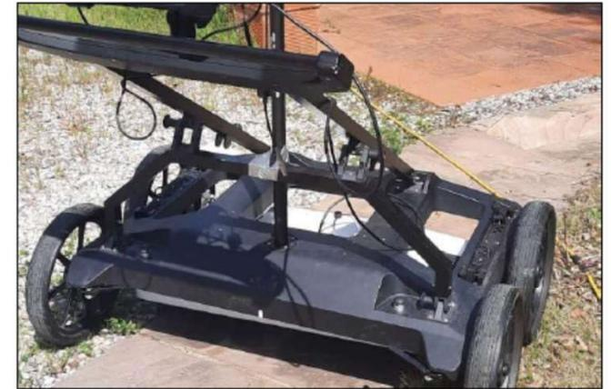
Figure 46 : IDS Stream DP à 30 antennes et fréquence 600 MHz poussé manuellement par un opérateur
