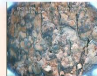
Colmatages de type physicochimique (hydroxyde de manganèse, incrustation d'hydroxyde de fer et de carbonates, corrosion par piquage)
