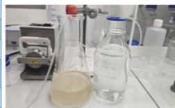
Effluent initial (gauche) et effluent traité avec MFH (droite)
